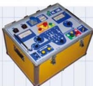
**Seguridad:** Pulsador de accionamiento manual que desconecta todo el Laboratorio Portable en caso de emergencia, poniendo a tierra sus salidas. Y Contacto de cerradura operable con llave de seguridad extraíble, para habilitar la puesta en marcha de los equipos de alta potencia.
